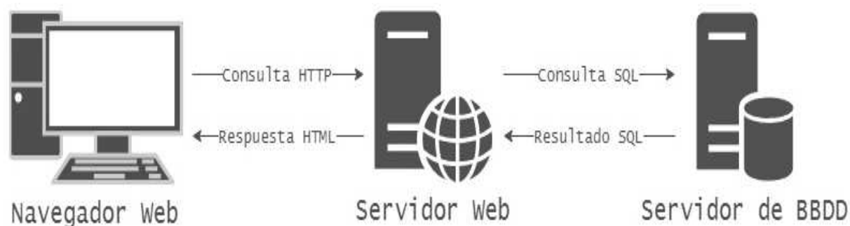
Fig. 2.5 Arquitectura Web en 3 capas.
