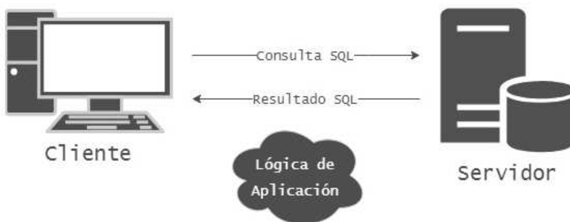
Fig. 2.2 Sistema Distribuido en 2 capas o Cliente/Servidor clásico.
