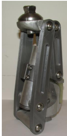
Figura 9: Prototipo construido de prótesis de rodilla policéntrica de cinco barras con incremento de estabilidad en fase de apoyo.
