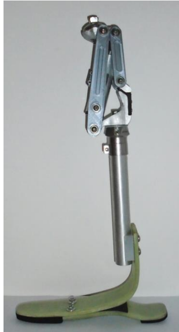
Figura 10: Prototipo construido de prótesis de rodilla policéntrica de cinco barras con incremento de estabilidad en fase de apoyo, integrado a prótesis de pie en material compuesto
