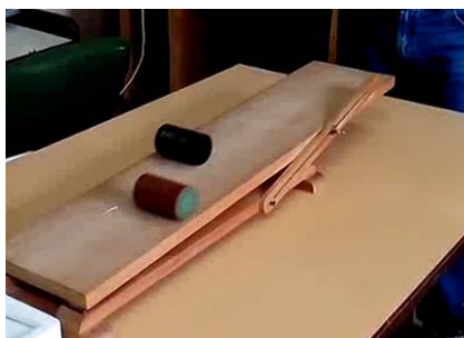
FIGURA 2. Se puede observar que el cilindro macizo va a llegar primero al pie del plano inclinado.
