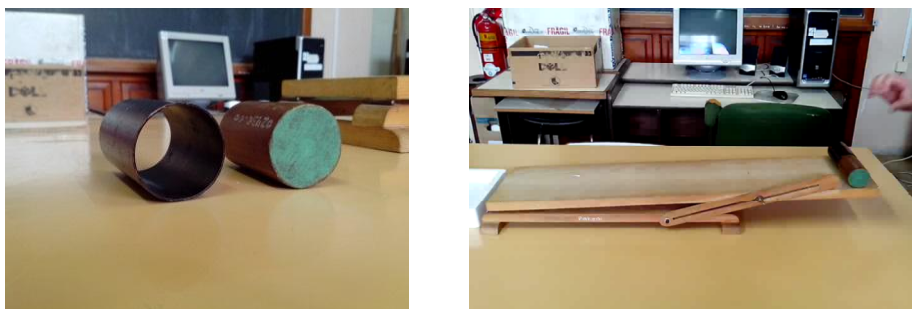
FIGURA 1. En la parte izquierda de la figura se muestra el cilindro macizo y el hueco empleados en la experiencia y en la derecha el esquema de la situación inicial, en el instante en que se liberan los cuerpos.
