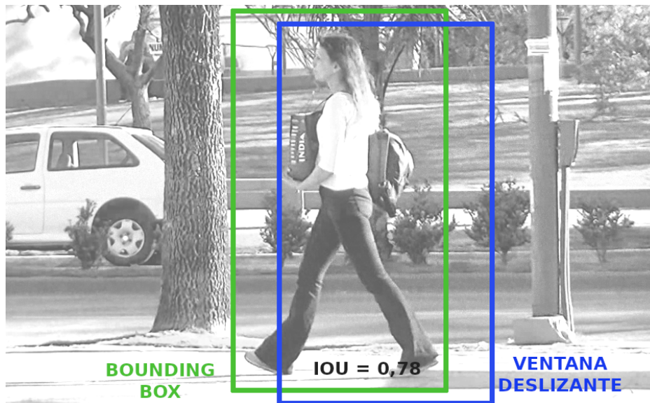
Figura 2.14 Cálculo del IOU a partir del BB del peatón y la ventana deslizante en su posición actual.
