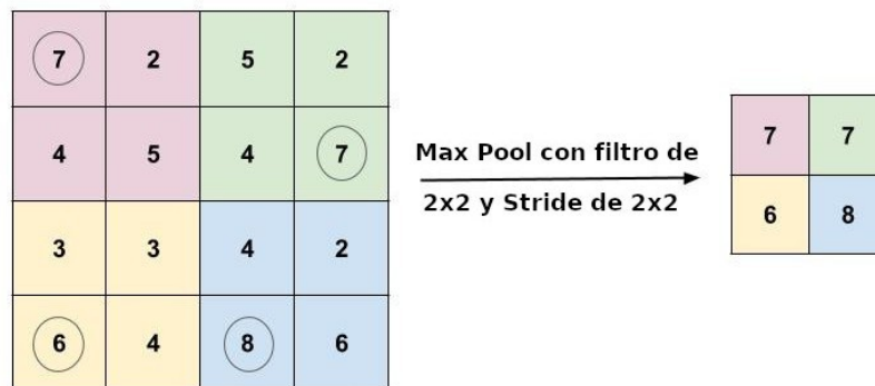
Figura 3.11 Proceso de Max Pooling, el feature map resultante es más reducido.
