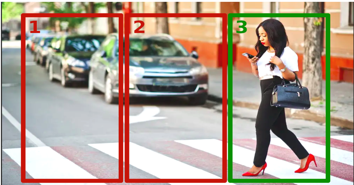
Figura 2.13 Cada ventana deslizante tiene su número. En la ventana deslizante número 3 el clasificador dio positivo.
