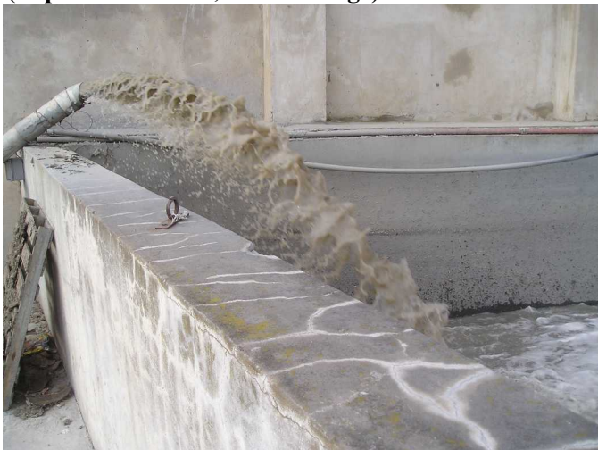
FIGURA 8: Efluente crudo (sin tratar), proveniente del proceso de fabricación del papel reciclado (Papelería Platense, ex-San Jorge).
