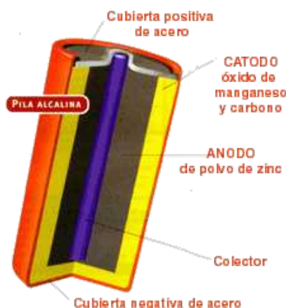
Figura 5: Esquema de una pila alcalina
