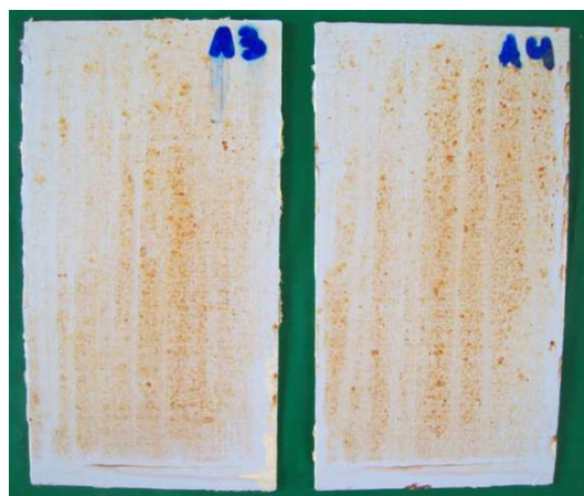
Imagen 2. Probetas de acero SAE 1010 después de 24 hs de exposición en cámara de humedad
