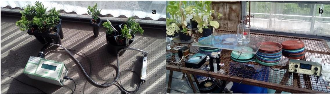
**Figura 16.** (a) Medidor portátil de fluorescencia modulada de la clorofila; (b) Dispositivo (electrodo tipo Clark) utilizado para realizar las mediciones de la actividad fotosintética a saturación de CO<sub>2</sub>. Ensayos realizados en el INFIVE (CONICET-UNLP)
