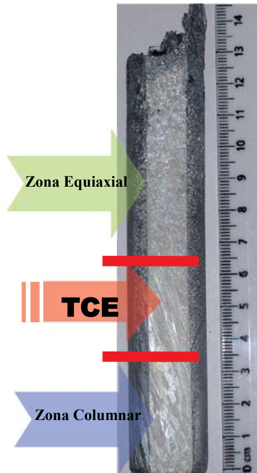
Figura 1. Probeta de Zn indicando la posición donde se produce la transición de estructura columnar a equiaxial, TCE.
