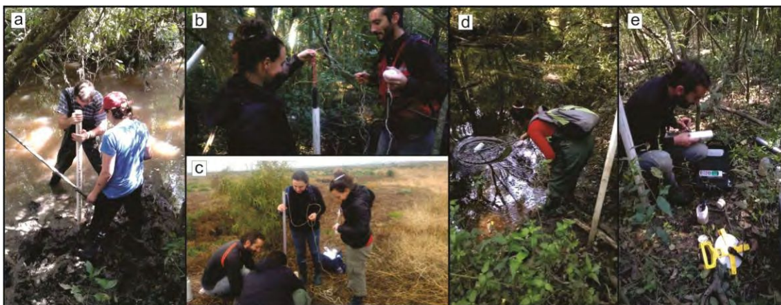
Figura 2.5: a) Freatímetro realizado mediante barreno manual; b) Instalación de sensores de registro continuo de nivel y temperatura de agua subterránea; c) Limpieza de pozo y muestreo de agua subterránea en uno de los freatímetros mediante el uso de un bailer; d) Muestreo de agua superficial en el arroyo Las Cañas; e) Medición in situ de pH, temperatura y conductividad eléctrica del agua.
