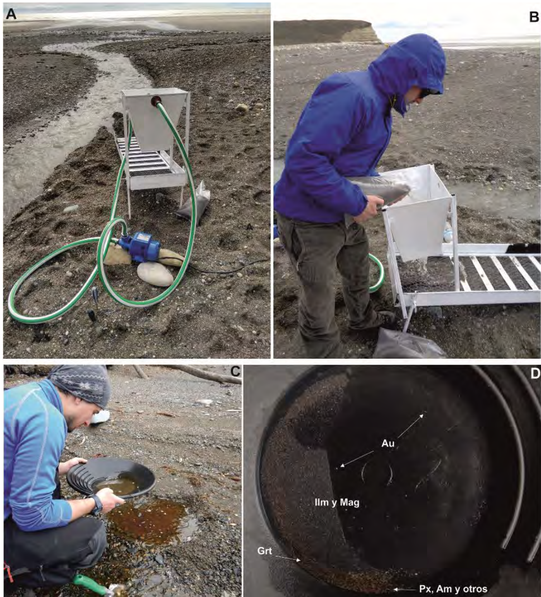
Fig.5.42. Métodos de concentración de oro: A y B mediante el uso de una canaleta, C y D con una batea.
