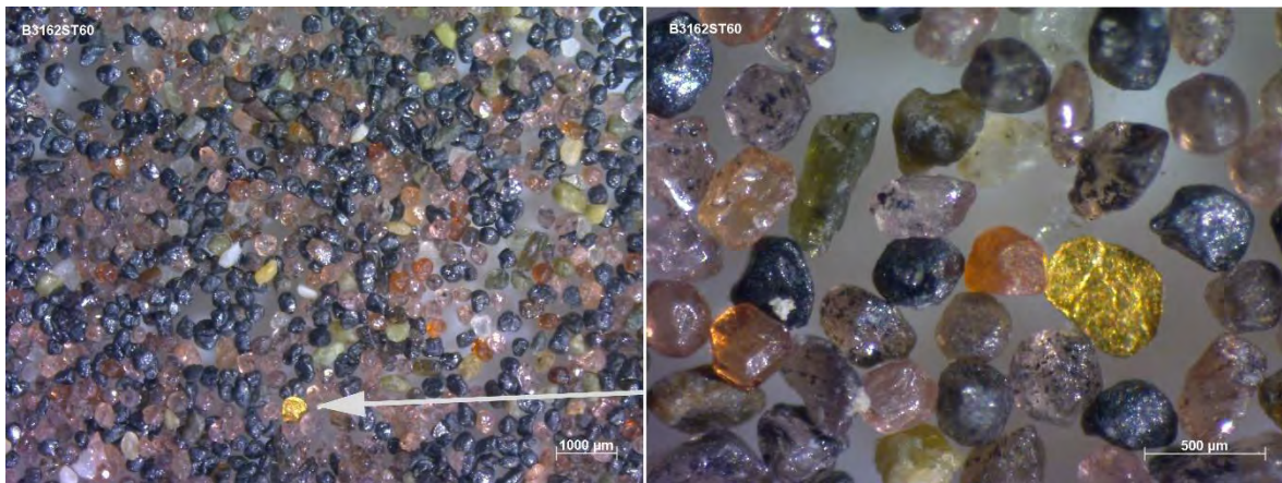
Fig.5.32. Fotografía con lupa binocular de concentrado de minerales pesados procedente de la playa del cañadón Beta. Hacia la parte inferior (flecha) nótase grano de color amarillo de oro en hábito laminar. En la ampliación de la fotografía de la derecha se diferencia además granates de color rosado-anaranjado, ilmenitas s.l. y magnetitas s.l. como minerales opacos y algún piroxeno de color verde.
