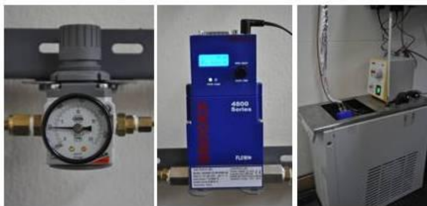
Figura 3.2.a- Reguladores de línea, caudalímetro másico y baño termostático.
