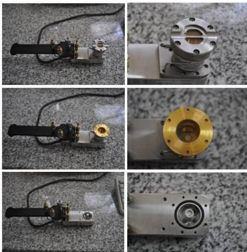
Figura 3.2.f- Detalle de la celda de DRIFT.
