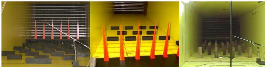
Figura 11. Imágenes de rugosidades en el Túnel de Viento.
