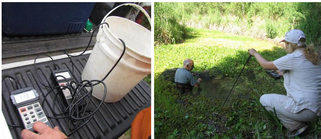
**Figura 27.** Fotos de las sondas limnológicas digitales utilizadas para las mediciones de oxígeno disuelto, conductividad, temperatura del agua, pH. a- calibración; b- medición in situ.
