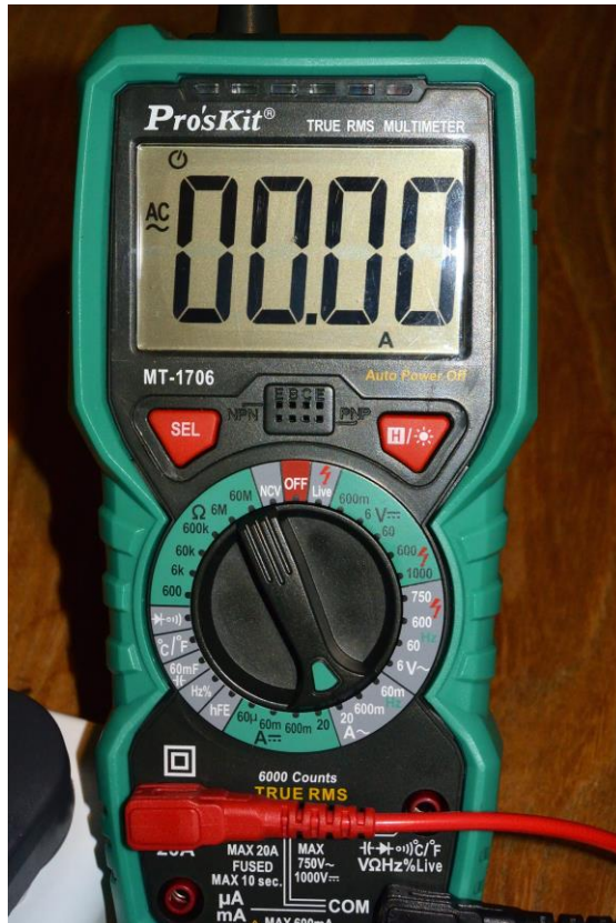
Figura AII.5 - Dispositivo ProsKit MT-1706 (vista superior encendido). Fuente: Propia.
