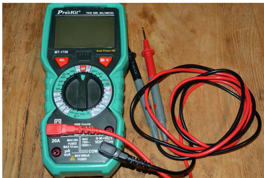
Figura All.4 - Dispositivo Proskit MT-1706 (vista superior, apagado). Fuente: Propia.
