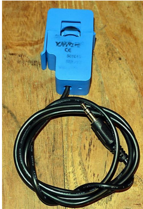
Figura All.1 - Pinza SCT 013-030 (vista cerrada). Fuente: Propia.
