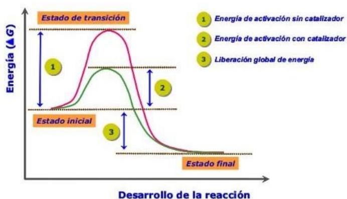
Esquema 1. Curvas de energía de activación de una reacción química, con catalizador (2) y sin catalizador (1).
