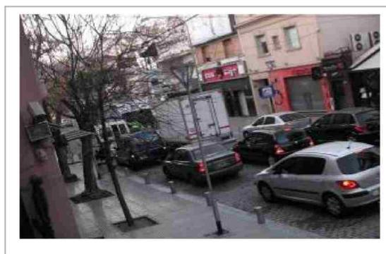
Los bolardos, dispuestos sobre eje de cordón, evitan el estacionamiento sobre la vereda. Aquí el ancho de la misma permite además incorporar el arbolado urbano. Importa señalar que la ocupación de la vereda debiera dejar un ancho libre del 75%, para exclusiva circulación del peatón
