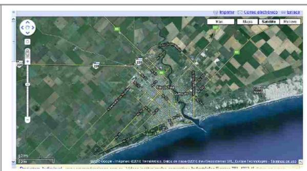
En las figuras 3 y 4 se observa la estructura vial que define el acceso al puerto Ququén en Necochea, vinculada a la red vial principal, del territorio, mediante colectoras que a modo de circunvalación, vinculan el propio puerto con la red vial troncal conformada por la RN 238, RP 86, RP 88, y RP 227.
