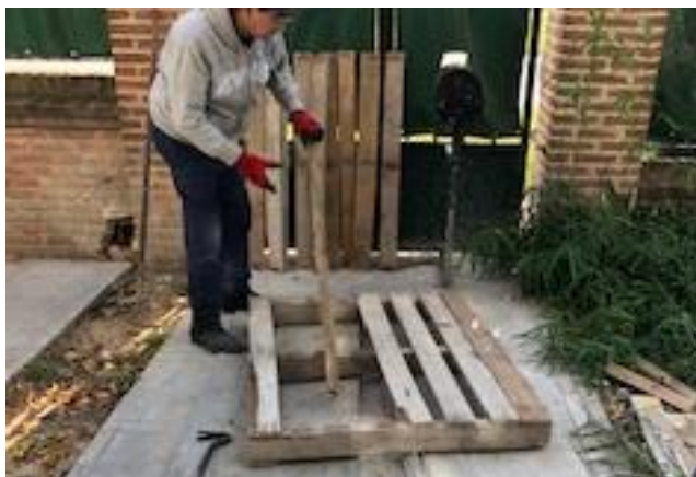
Figura 1 desarmado y recuperación de madera de Pallets
