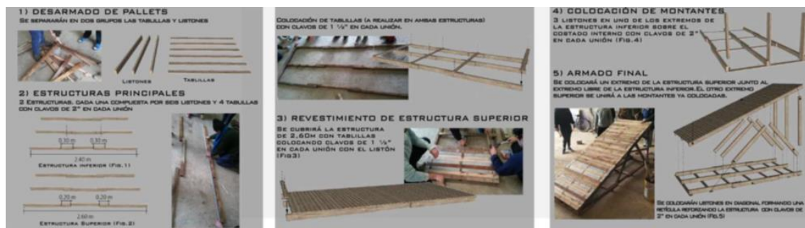
Figura 7 instructivo de armado de Techo
