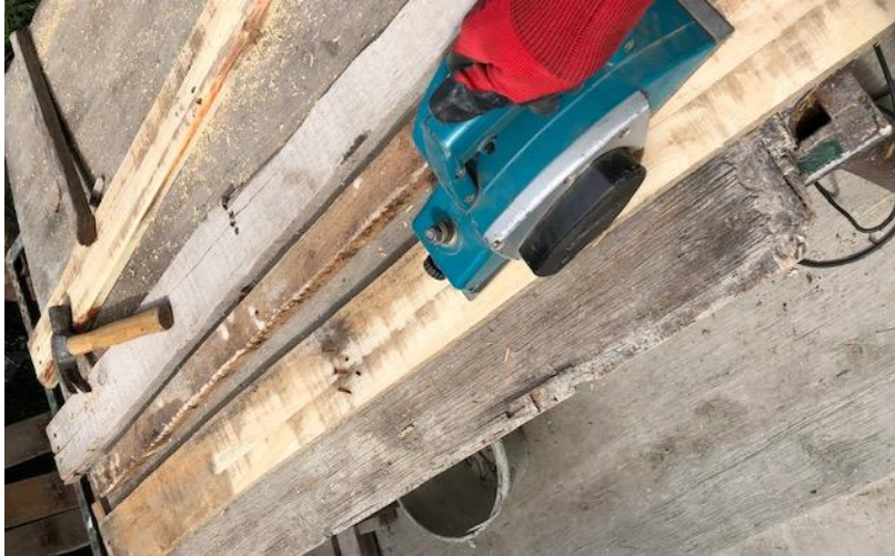
Figura 4 cepillado de madera recuperada
