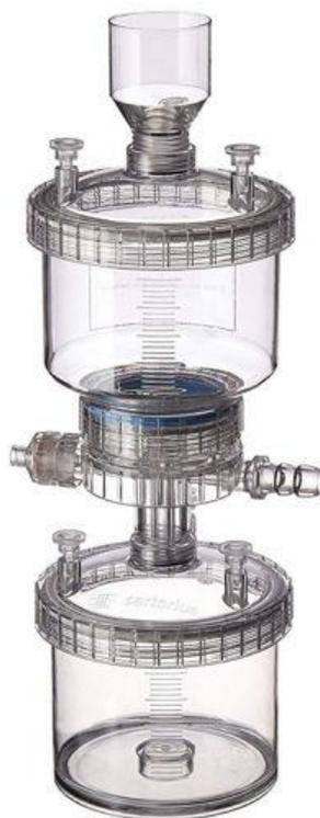
*Figura 3.1. Soporte de filtro de policarbonato.*
