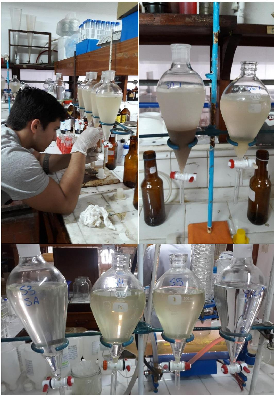
*Figura 3.8. Extracciones líquido-líquido en ampollas de decantación.
