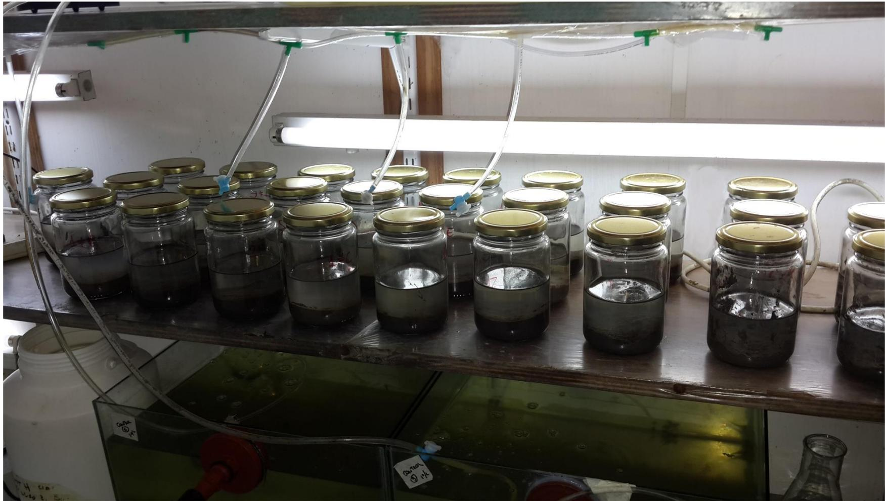
*Figura 6.5. Bioensayo de toxicidad de sedimentos en cuarto climatizado y con fotoperiodo.*
