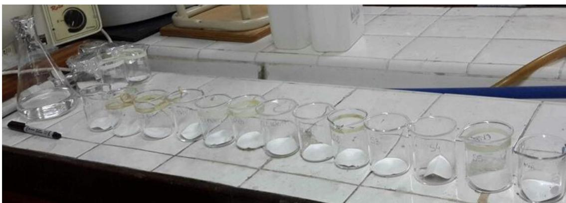
*Figura 3.10. Vasos de precipitado con filtros para extracción sólido-líquido.
