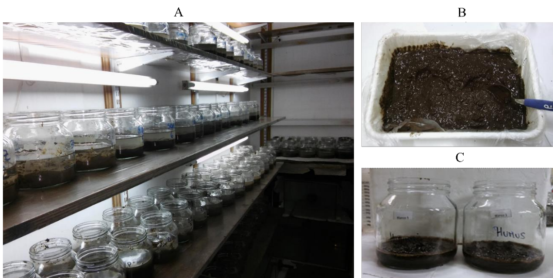
Figura 3.2 A- Cuarto de ensayo donde se realizaron los experimentos con las cámaras de ensayo. B- Homogeneización del sedimento. C- cámaras de ensayo con sedimento.
