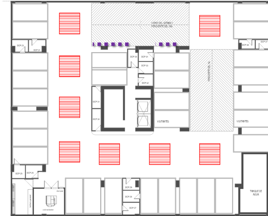
Figura 55. Esquema de ventilación natural sótano 2
