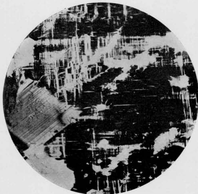
2. Adamellitita (12). Microclino mostrando venas albíticas de reemplazo de forma irregular, y pertitas de exsolución delgadas, rectas y discontinuas. También se observa el maclado característico. \times 63 . Nic. +
