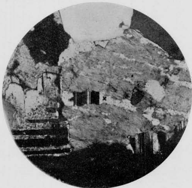
2. Granito (3). Penetración de plagioclasa albítica en feldespato potásico. La vena conserva la misma orientación que el cristal de donde procede, hasta el punto x, en donde cambia para adaptarse a la de la ortoclasa, haciéndose al mismo tiempo más albítica. \times 63 . Nic. +
