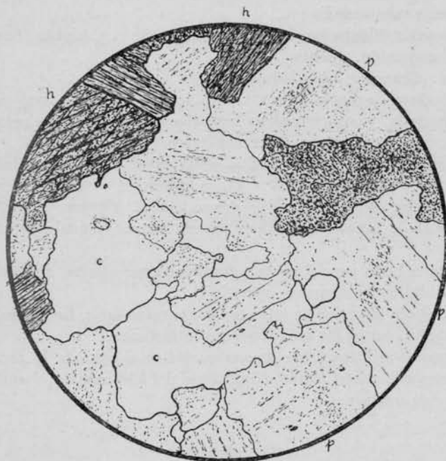
Fig. 10. — Tonalita (29) : p, plagioclasa ; c, cuarzo ; h, hornblenda, algo cloritizada
