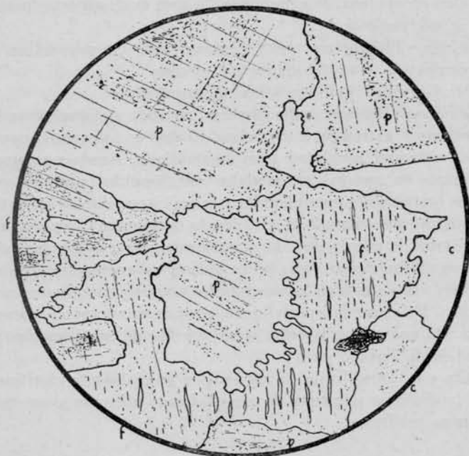
Fig. 8. — Granodiorita (7) : p, plagioclasa ; f, feldespato potásico ; c, cuarzo. Nótese la penetración del margen albitico de la plagioclasa en el feldespato potásico. Hay también pertitas de reemplazo.
