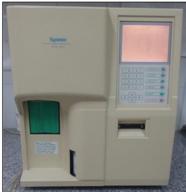
Figura 1: Contador hematológico Sysmex K-21 utilizado para el procesamiento automatizado de las muestras sanguíneas.
