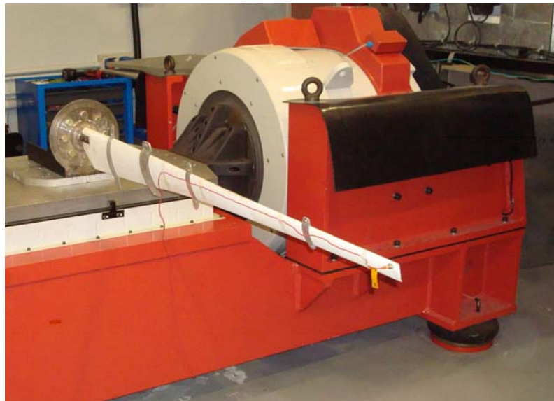
Figura 2: Pala en vibrador, con acelerómetro.
