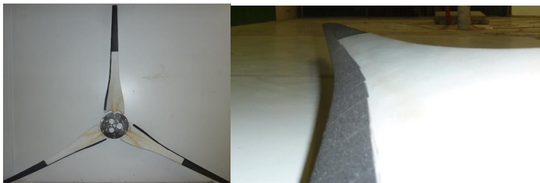
Figura 3. Vista frontal del aerogenerador con lijas que ocupan el 15% de la cuerda
