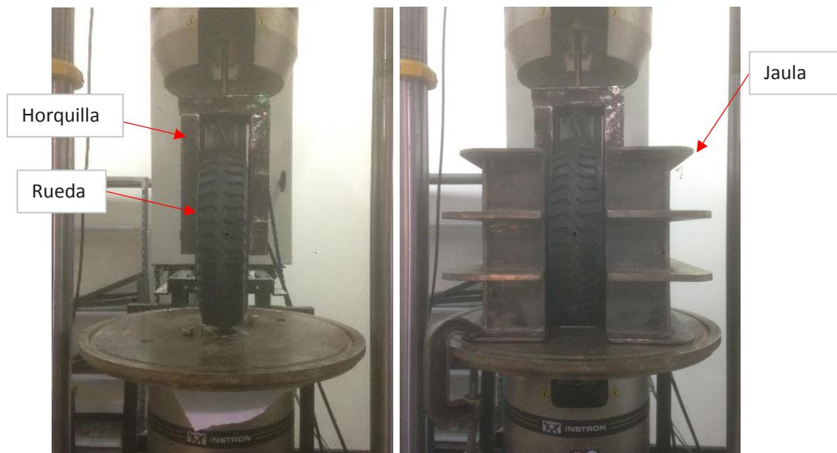
Figura 2 – Dispositivo de ensayo.
