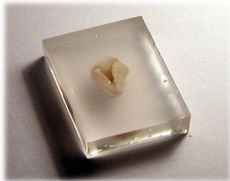
Fig. 1. Muestra incluida en resina epóxica
