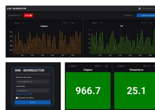
**Adquisición y visualización de datos:** en los ensayos se usó una Raspberry Pi 3 B+ con un panel táctil y software ad-hoc (Python + Matplotlib). Adicionalmente, se está desarrollando una aplicación web (node.js + PostgreSQL + Dygraphs) que agrega configuración del proceso y lazos, gestión de usuarios y permisos, y exportación de datos.
