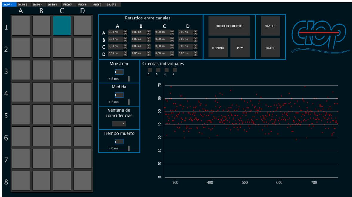
**Figura 3.10:** Interfaz gráfica para facilitar la comunicación entre la FPGA y la PC. El arreglo de botones de la izquierda permite configurar los canales a medir en coincidencias para cada salida. En la parte inferior derecha se encuentra el gráfico que muestra en tiempo real las cuentas registradas, y alrededor, las cajas de texto que permiten configurar los parámetros de la placa y de medida
