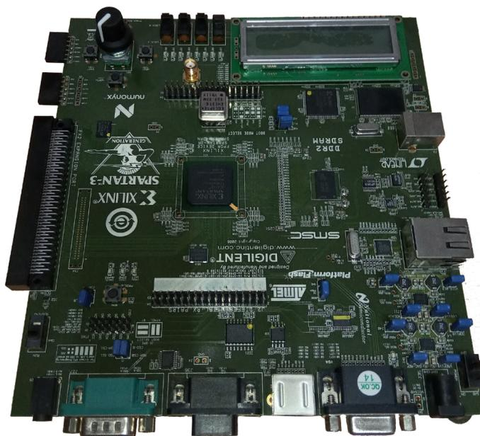
**Figura 3.2:** Foto real de una placa de desarrollo de prototipos FPGA (Xilinx Spartan-3A XCS3S700A).
