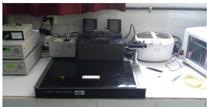
Figura 4: Generación de \mu -taper en fibra óptica mediante un arco eléctrico en simultáneo con una acción de tracción (izquierda), montaje experimental para la implementación de LPGs inducidas mediante arco eléctrico (derecha).
