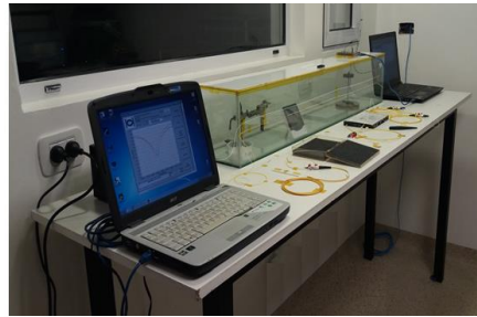
Figura 5: arreglo experimental montado para la determinación de la sensibilidad de la LPG a la HR.
