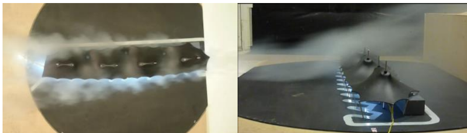
Figura 10. Visualización con humo, vista superior y con obstáculo.
