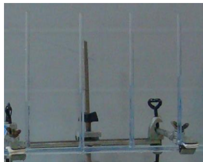
Figura 13. tubo de vidrio con cuatro piezómetros.
