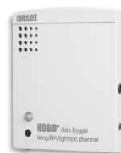
Figura 5: Acumulador de datos tipo HOBO U12-006
