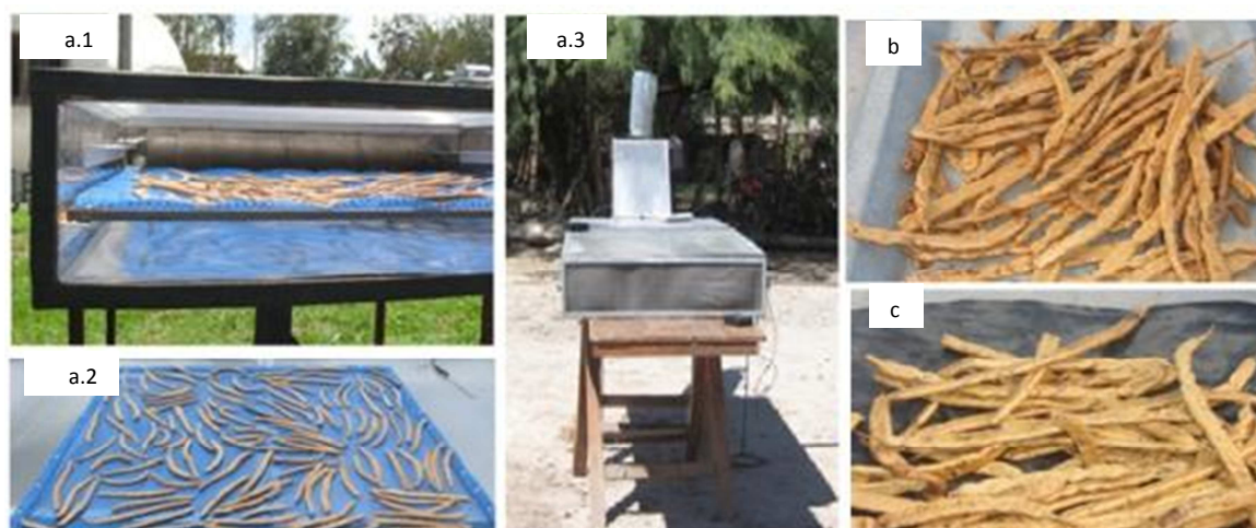
Figura 1. Métodos ensayados para el secado de los frutos de Prosopis alba , a.1 cámara de secado, a.2 bandeja, a.3 Secador solar, b. Secado sobre chapa de cinc, c. Secado sobre plástico negro.
