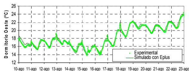
Figura 1: Esquema para EnergyPlus de la zona a calefaccionar (izquierda) y resultados del monitoreo experimental y de la simulación térmica para un periodo de invierno (derecha).
