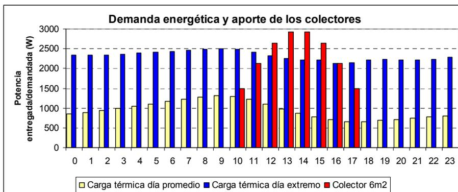
Figura 5. Carga horaria de calefacción de la zona para un día de invierno con temperaturas promedio y aporte de un colector solar de 6 m² de área de colección.
