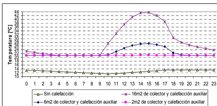
Figura 7. Temperatura de la zona sin calefacción y con el aporte de calefacción auxiliar para alcanzar 21°C y de colectores solares para 16 m<sup>2</sup>, 6 m<sup>2</sup> y 1m<sup>2</sup> de área de colección, para un día promedio de invierno..
