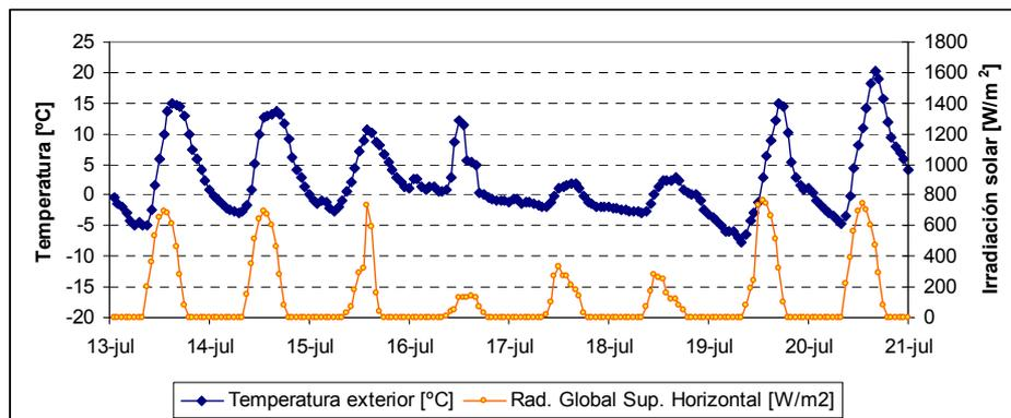
Figura 2. Temperatura exterior y radiación solar sobre superficie horizontal para el periodo comprendido entre el 13 y el 20 de julio de 2010.
