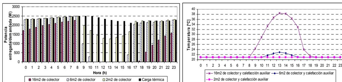
*Figura 8. Izquierda: calefacción auxiliar requerida para satisfacer la carga térmica horaria suponiendo que los colectores funcionan a pleno entre las 10:00 y las 17:00, para un día extremo de invierno. Derecha: Temperatura de la zona con el aporte de calefacción auxiliar para alcanzar 21°C más el aporte de colectores solares para 16 m<sup>2</sup>, 6 m<sup>2</sup> y 1m<sup>2</sup> de área de colección.*
