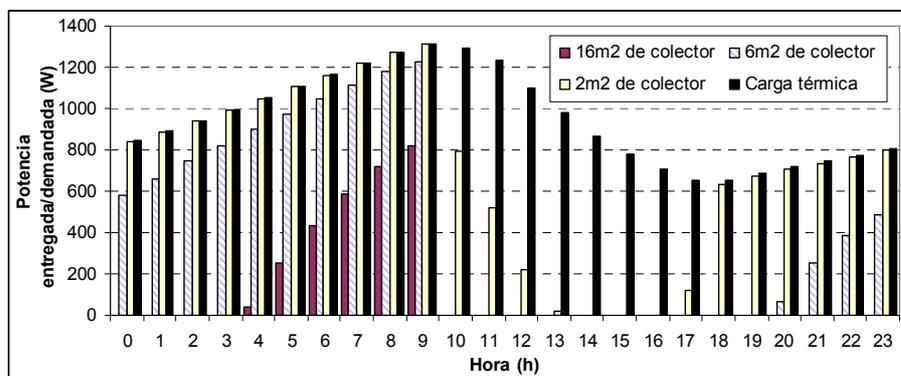
Figura 6. Calefacción auxiliar requerida para satisfacer la carga térmica horaria suponiendo que los colectores funcionan a pleno entre las 10:00 y las 17:00, para un día promedio de invierno..
