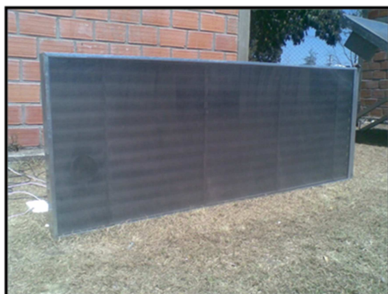
Figura 2: Colector solar ensayado en circuito abierto.
