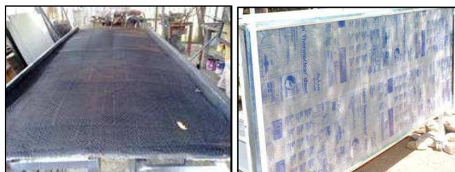
Figura 2: Colocación del material poroso como absorbedor. Colector terminado con cubierta protectora.
