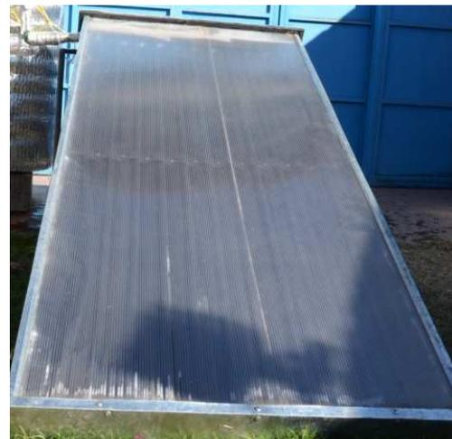
Figura 3. Fotografía del colector con la cubierta de policarbonato
