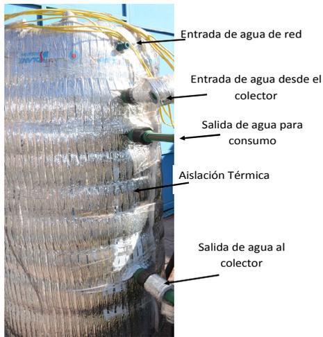
Figura 2. Fotografía del tanque con 120 litros
