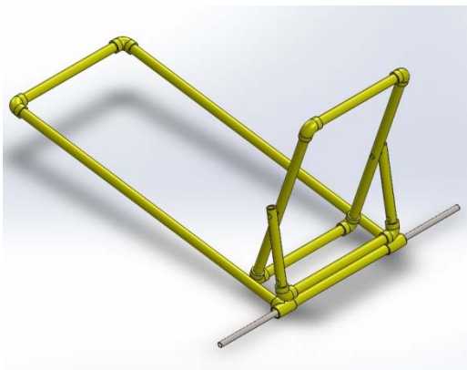
Figura 6: bastidor y respaldar con estructura de caños de termofusión.
