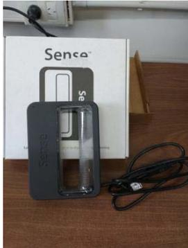
Fig.3 - Escáner 3D.
