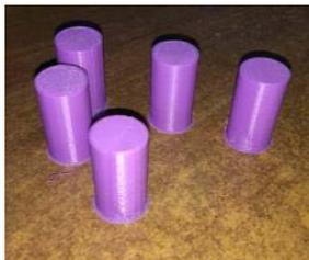
Fig.11 – Probetas para compresion ABS
