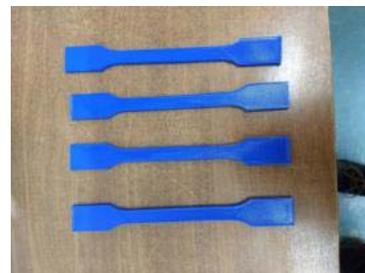
Fig.8 – Probetas para tracción PLA
