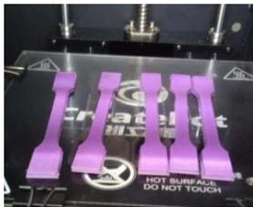
Fig.10 – Probetas para tracción ABS
