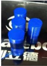
Fig.9 – Probetas para compresion PLA
