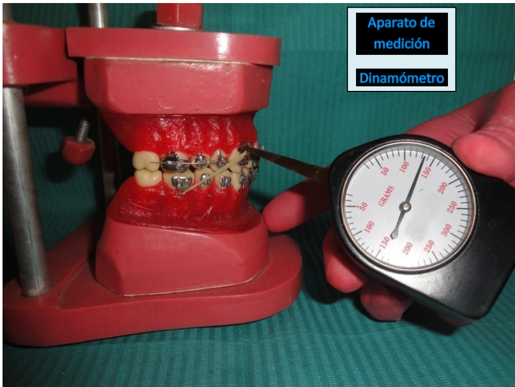
Ilustración 5 Aparato de medición de fuerza de las gomas intermaxilares. Marca: Jinan Kason T. E. Fuente Primaria.
