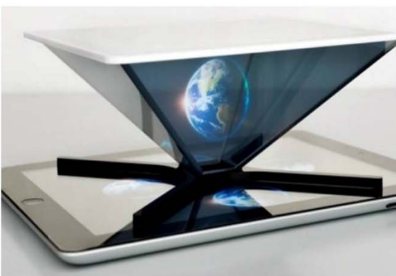
Fig. 2 – Smartphone e tablet possono diventare visualizzatori di modelli tridimensionali attraverso la Realtà Aumentata o proiettori olografici costituiti da una piramide di vetro che riflette l'immagine visualizzata sullo schermo dei devices ricreando così, l'illusione di un oggetto sospeso all'interno della piramide stessa.
