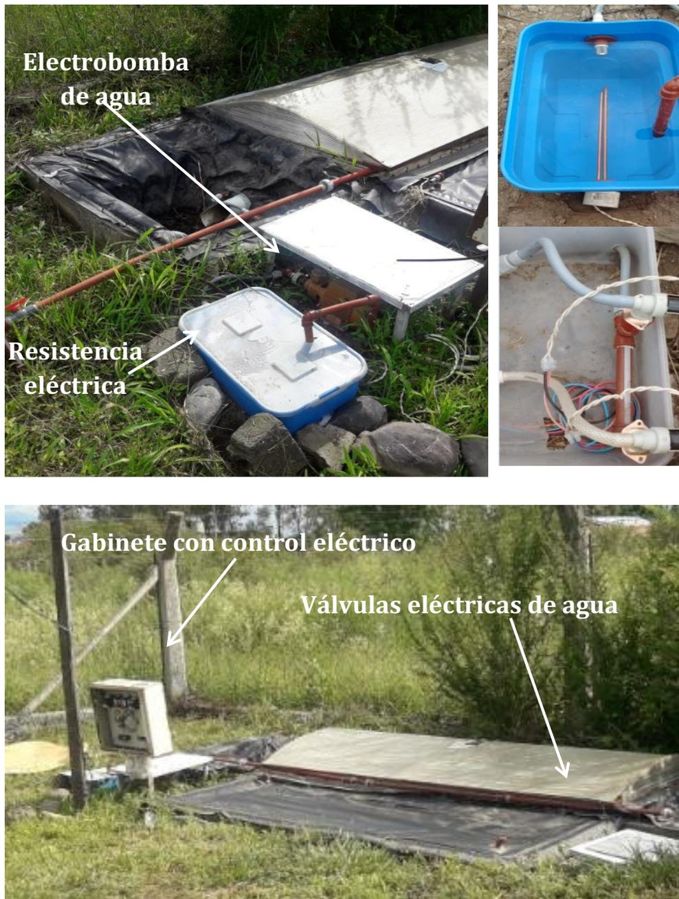
Figura 6.27. Imagen de la electrobomba, resistencia eléctrica, válvulas eléctricas y gabinete eléctrico.
