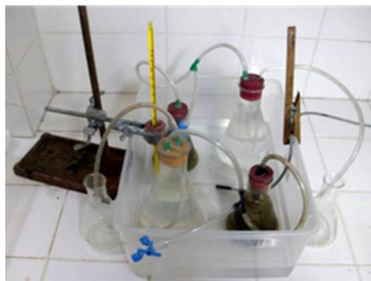
Figura 4.2. Esquema y foto del ensayo de biodigestión realizado en el laboratorio.
