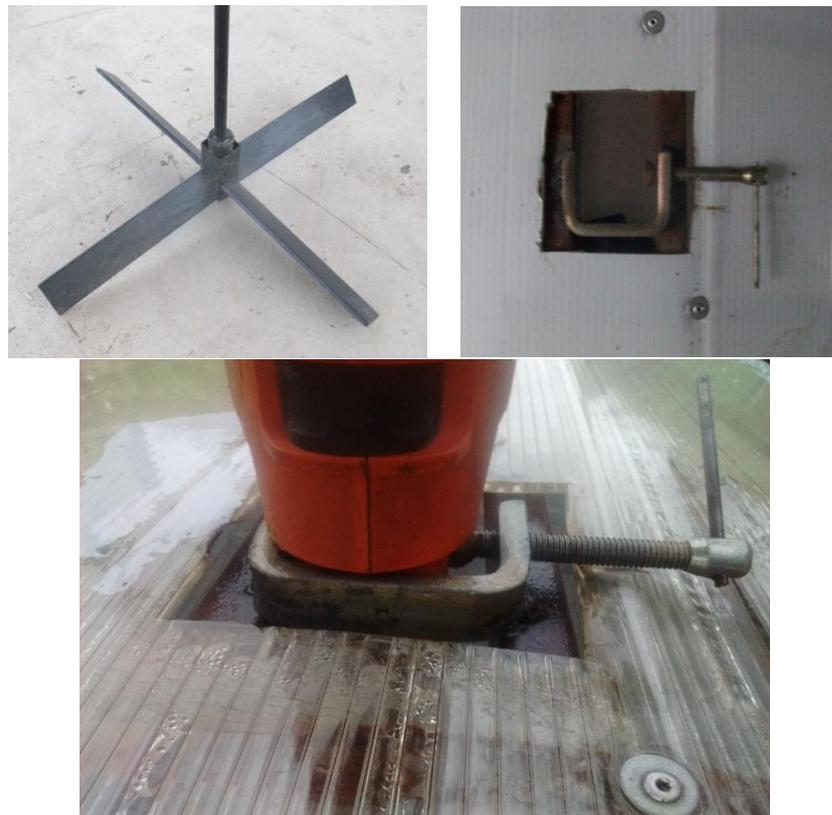
Figura 6.26. Mezclador y sistema de sujeción.
