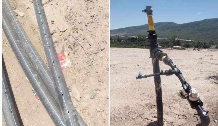
Figura 1.8. Vistas de los tubos perforados y válvula de muestreo.
