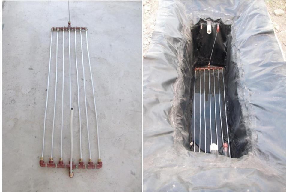
(a) vista del intercambiador de calor solo y colocado en el digester.
