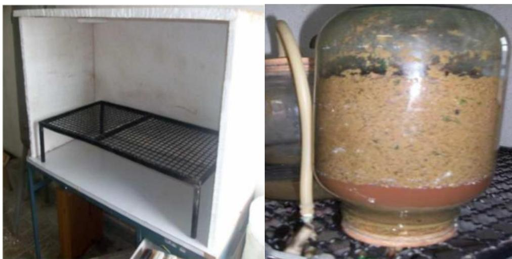
Figura 4.9. Imagen de la cámara con la parrilla y el digester apoyado sobre ella.
