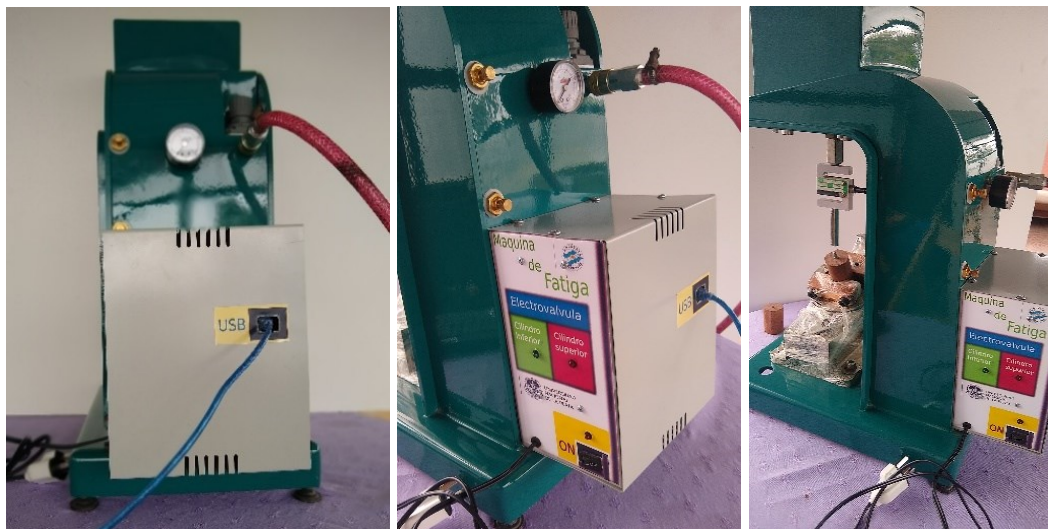
Ilustración 28: Posicionamiento final del gabinete
