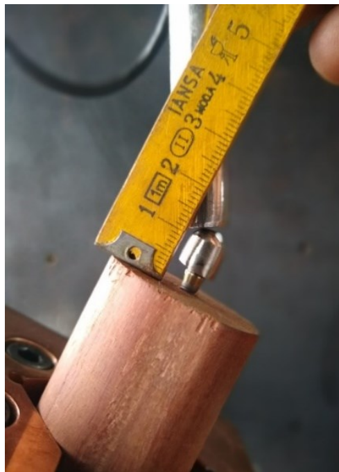
Ilustración 23: Posicionamiento del implante y verificación de altura según norma 14801
