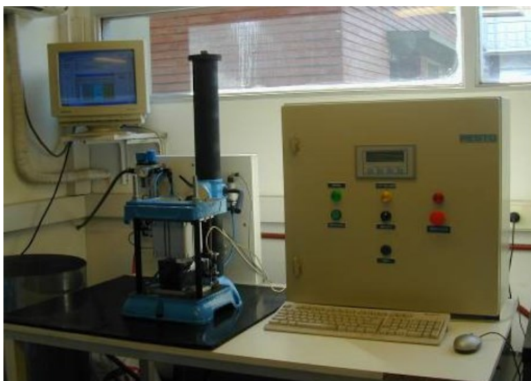
Ilustración 3: Máquina de fatiga desarrollada por el INTI
