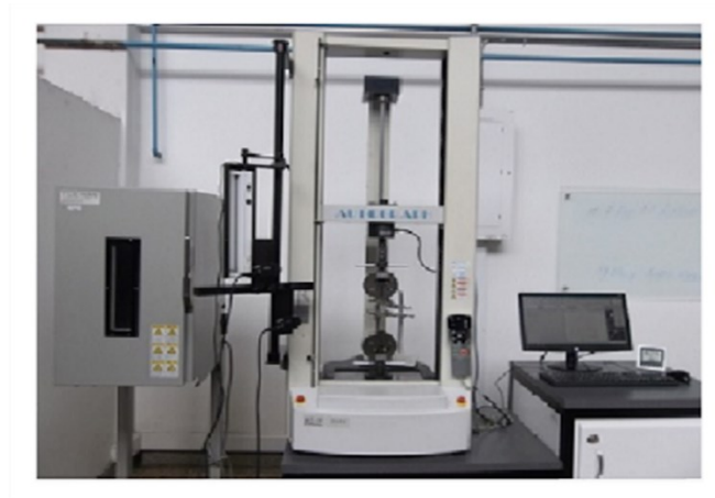
Ilustración 2: Máquina de ensayos marca Shimodzu modelo Autograph AG-IS 5KN
