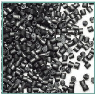
**Figura 2.** Polyetheretherketone (PEEK) compuesto puro.
