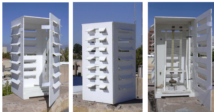
Figura 3: Abrigo meteorológico portátil diseñado y construido en el INEAA para contrastación con datos digitales
