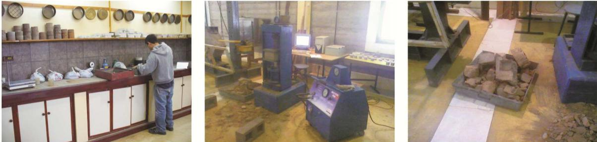
Figura 7. Ensayos de resistencia a la compresión de bloques de suelo-cemento.
