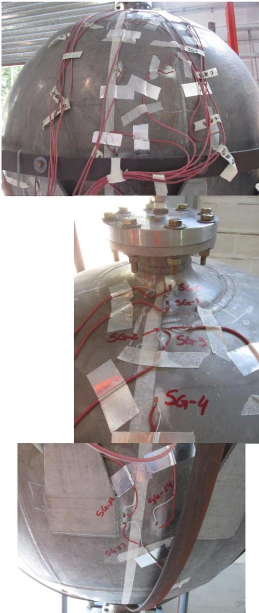
Figura 4. Strain Gages colocados sobre el tanque.
