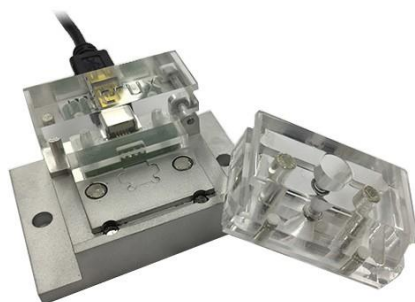
Fotografía 1. Bipotenciostato TEQ-03 (Nanoteq, Argentina)
