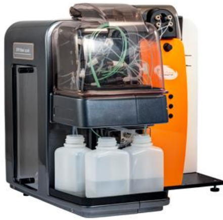
Fotografía 3. Equipo BioNavis 210A empleado para los estudios SPR.
