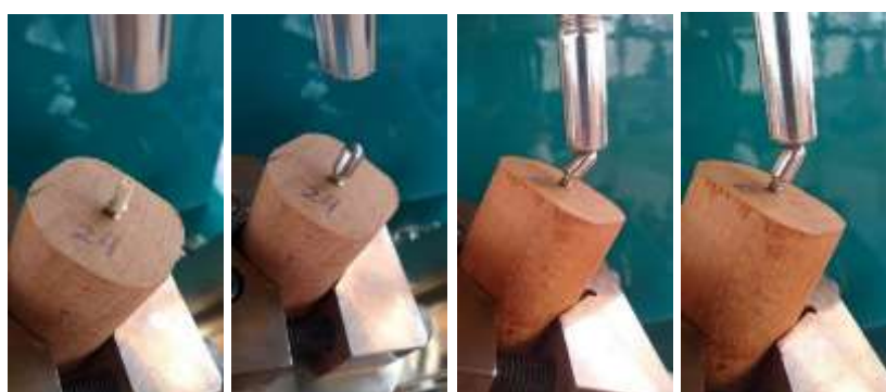
Ilustración 19: Implante con y sin casquillo en prueba de fatiga
