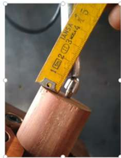
Ilustración 9: Posicionamiento del implante y verificación de altura según norma 14801
