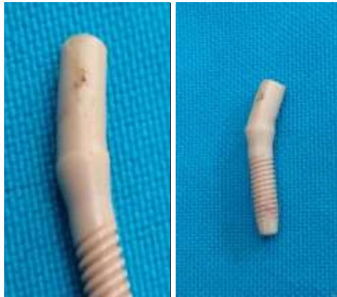
Ilustración 82: Deformación permanente implante peek monoblock
