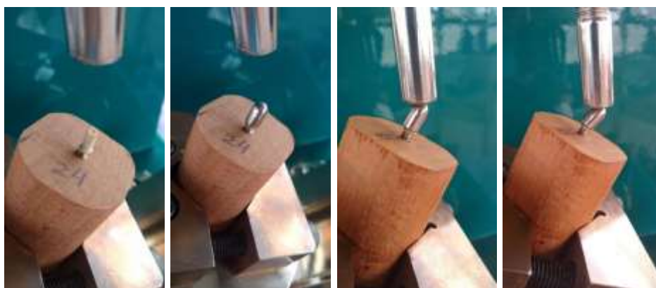
Ilustración 77: Implante con y sin casquillo en prueba de fatiga
