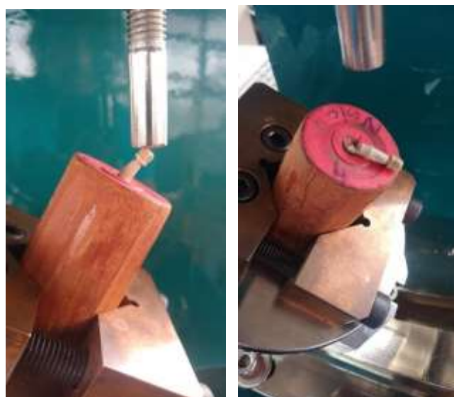
Ilustración 67: Rotura de implante monoblock
