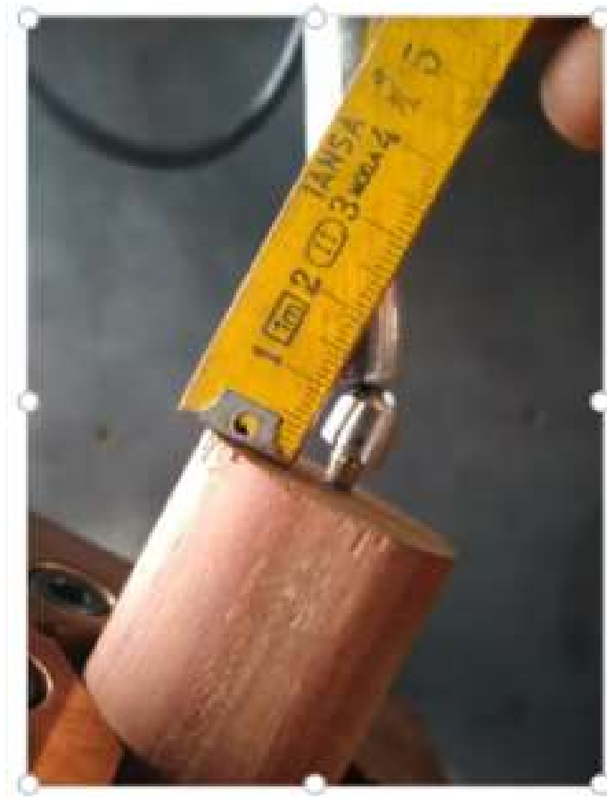
Ilustración 38: Posicionamiento del implante y verificación de altura según norma 14801
