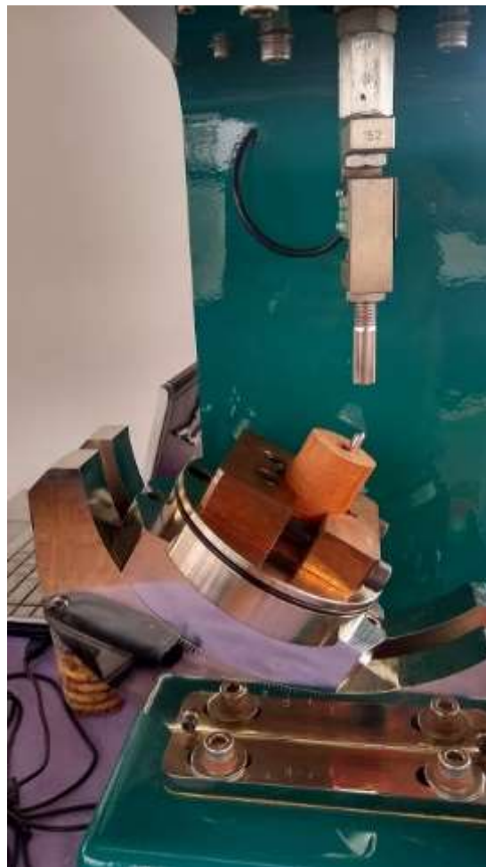
Ilustración 69: Posición correcta del implante en la prueba
