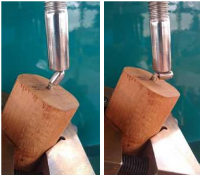
Ilustración 72: Rotura de implante titanio-pilar peek
