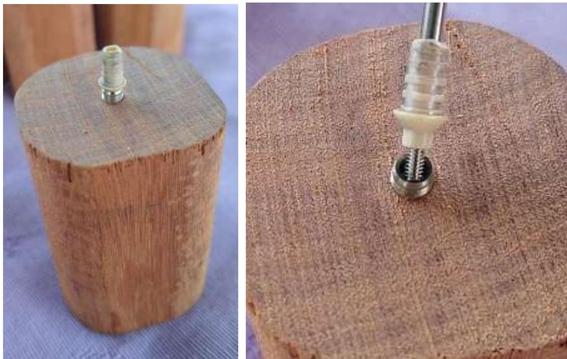
Ilustración 90; Integridad en la prueba de fatiga de pilar peek
