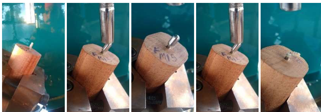
Ilustración 57: Muestra de grupo B en rotura
